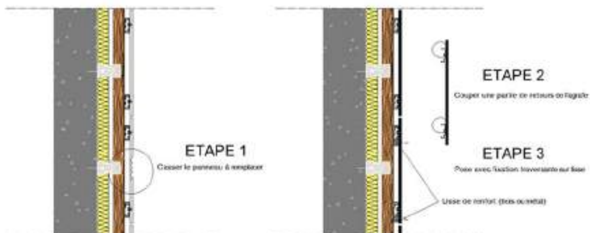
Figure 14bis – Démontage d'un panneau pour un ancrage d'échafaudage
