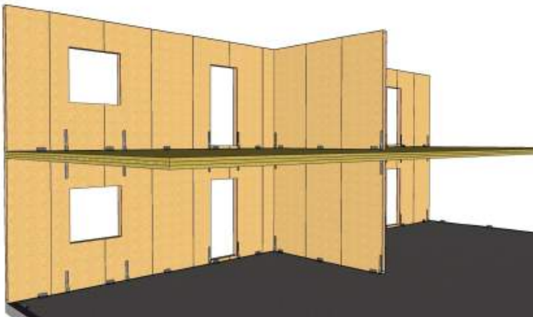
Figure 20 – Vue générale des panneaux assemblés sur plancher bois de type CLT, avec répartition des équerres de reprise du glissement et des équerres d'ancrage anti-soulèvement
