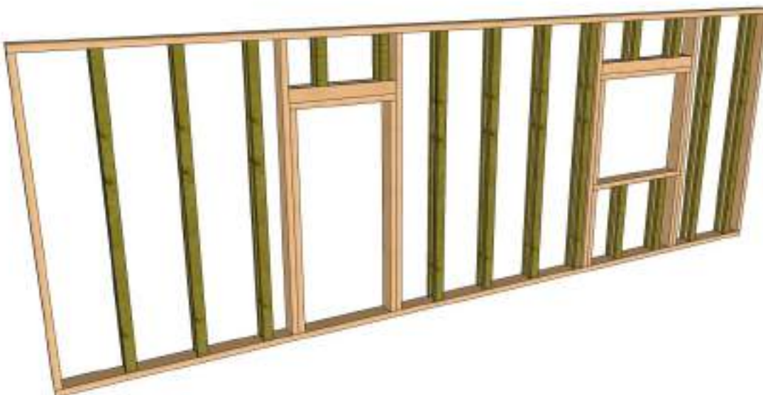
Figure 6 – Vue de l'ossature bois intérieure (poutres en I) d'un panneau de mur structurel LogiWall
