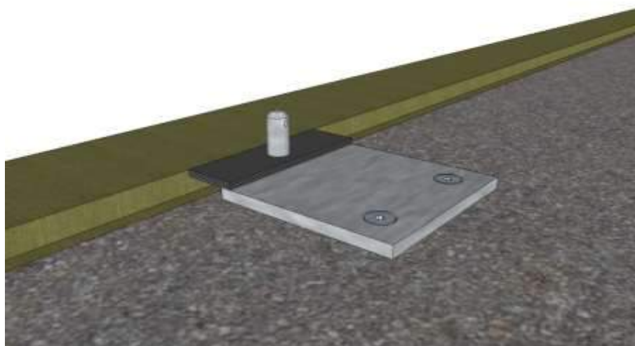
Figure 26 – Pose d'une bande de laine de roche horizontale entre panneaux d'étage (cas des façades indépendantes par niveau)
