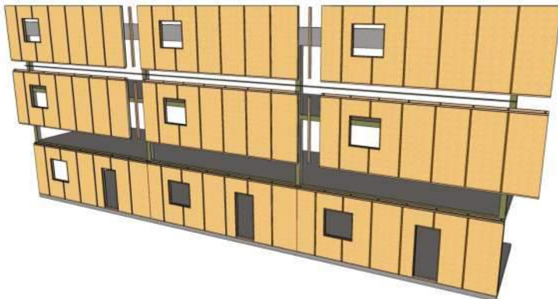
Figure 16 – Pose de l'ensemble des panneaux (cas des façades autoportantes)
