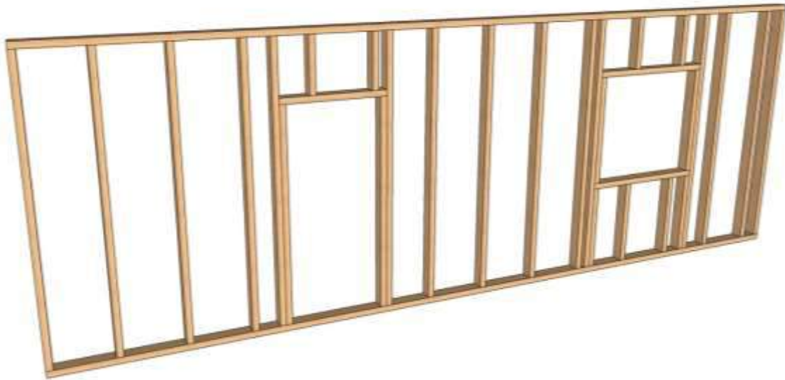
Figure 5 – Vue de l'ossature bois intérieure d'un panneau de façade LogiSkin
