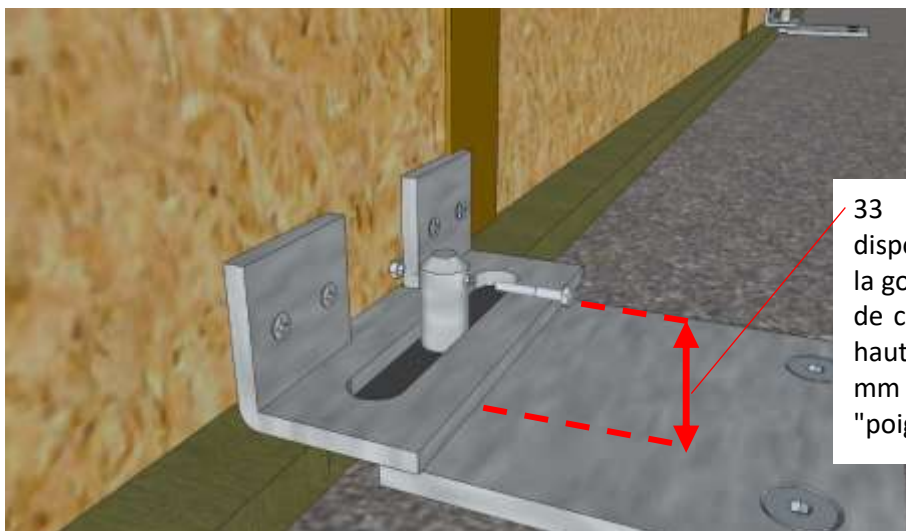
Figure 29 – Insertion d'un boulon ou goupille de sécurité anti-soulèvement en extrémité de l'axe vertical (cas des façades indépendantes par niveau)
