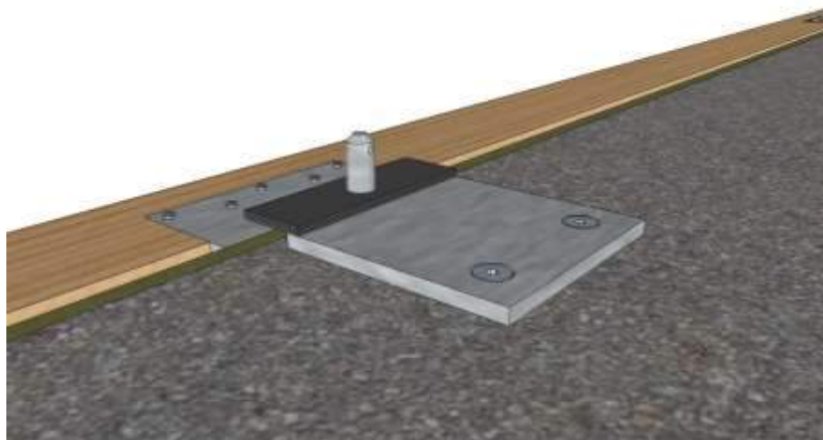
Figure 25 – Mise en place de cales pour régler le niveau général de la dalle (cas des façades indépendantes par niveau)
