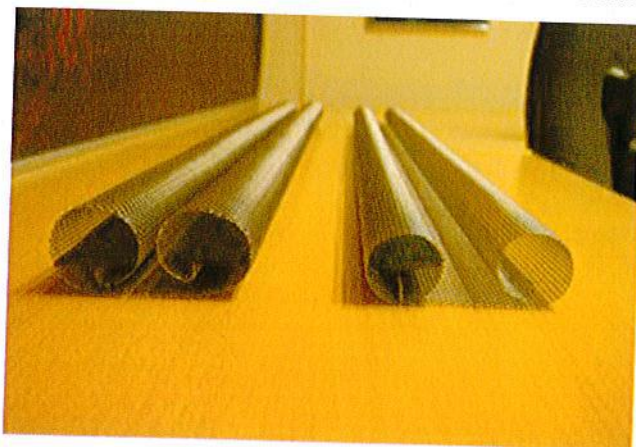
Figure 1: Vues d'ensemble du dispositif d'obturation de lame d'air
