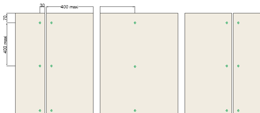
Figure 41 – Principe de la pose en sous-face
