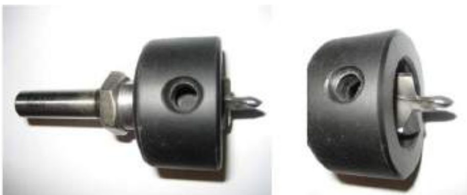
Figure 5 – Perceuse – fraiseuse pour fixations sur Equitone [linea] (diamètre 7mm)
