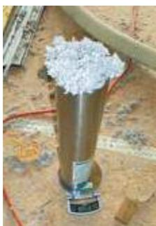
Échantillon de vérification de la densité. ©AQC-2015
