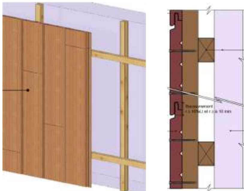
Figure 4 : Lames à emboîtement – pose verticale (illustration 3D et coupe horizontale)
