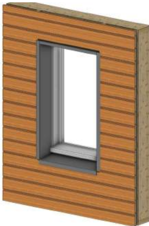
Figure 22 Exemple de mise en œuvre avec encadrement métallique – vue de face
