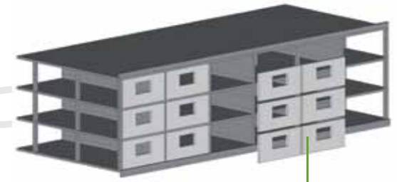
Structure poteau-poutre béton armé conservée
