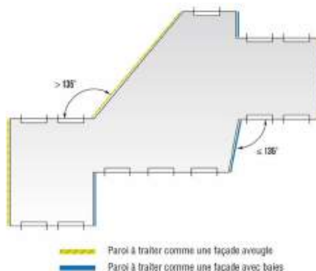
Figure 6 : Pose de bandes filantes sur des façades aveugles en fonction de géométrie du bâtiment (crédit [3])
