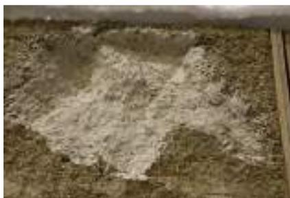
Photo 6 : béton de chanvre humidifié avec un coulis de liant de même composition que celui ayant servi à faire le béton de chanvre initialement.
