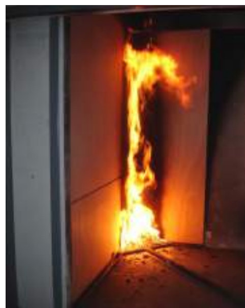
Photo 1: essai Européen de réaction au feu pour les parements.
