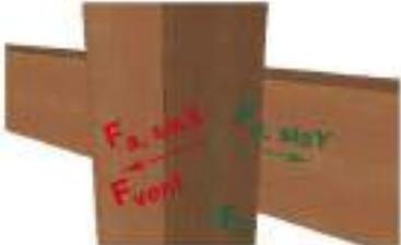
$F_{vent}$  Réaction horizontale perpendiculaire à la façade due au vent
